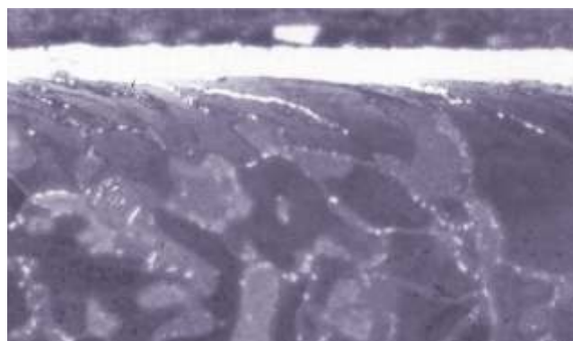
Devido à baixa temperatura de tratamento, não ocorre nenhuma recristalização, mesmo no caso de uma grande deformação da estrutura básica. Consequência: alterações dimensionais insignificantes.
