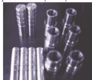
Para buchas e colunas normalmente é utilizado o material SAE 8620 e Nitretado a Plasma com camadas de 0,20 a 0,30 mm de profundidade.
